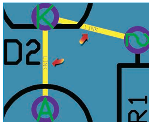
figura 8 Il segnale indicato collega componenti prima presenti in schemi diversi
